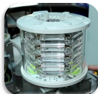
MIOL-A avec circuit de secours (TWIN version)
