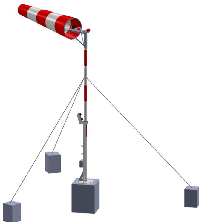
Le mât répond aux normes de l'OACI et de l'Aviation Civile (STNA). Il est basculant à sa base, mesure 4,20m, et est livré avec son système de basculement, sa platine de fixation et son système de relevage mouflé. Ses dimensions lui permettent d'être facilement installé en toiture de bâtiment.
